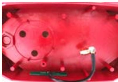
Veillez absolument monter l'antenne sur le côté illustré ici, puisqu'autrement la longueur d'antenne ne suffit pas.
