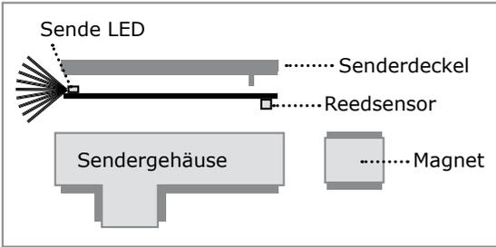
Das Sendergehäuse kann, je nach Rahmen und Platzverhältnissen bzw. Abständen zur Scheibe, liegend (links oder 180° gedreht- rechts) oder auf der Seite stehend befestigt werden. Während das Sendergehäuse gedreht wird, behalten die Platine mit Sende-LED, Reedsensor und Senderdeckel ihre Ausrichtung zum Magneten.
